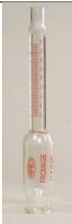
Butyromètre à fromage (Van Gulik)
