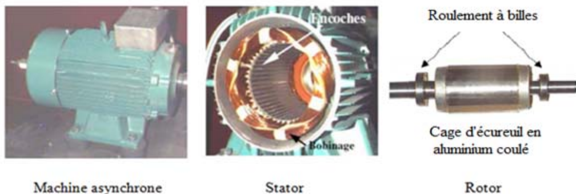
Figure II.1. a Photo d'une machine asynchrone avec le Stator et le Rotor qui la constituent
