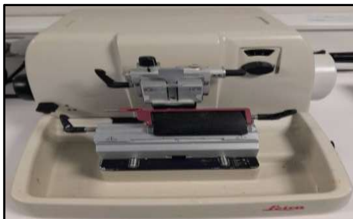
Figure 34 : Réalisation des coupes histologiques avec un microtome. / Microtome (LEICA2235) (photo personnelle, 2023).
