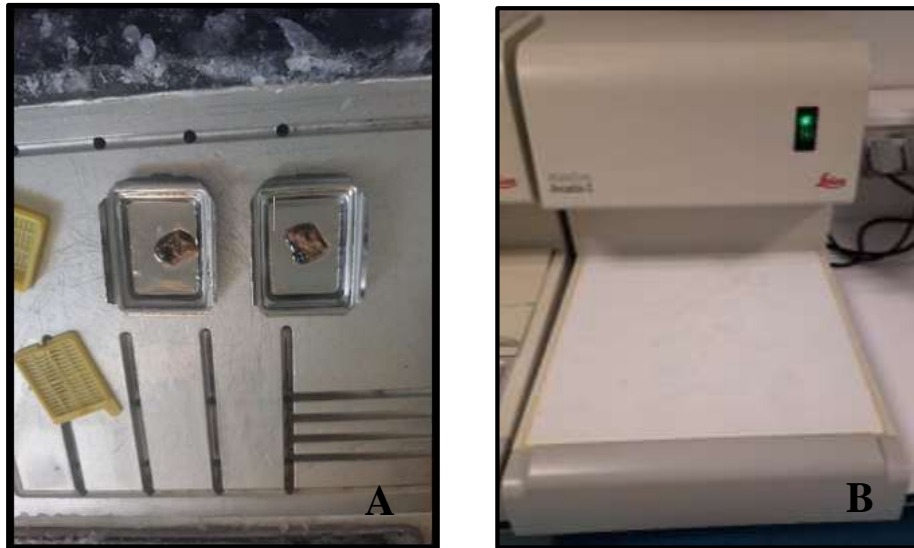
Figure 33 : Enrobage des échantillons et confection de blocs de paraffine (A) Échantillons disposés dans des moules en inox, (B) Plaque de refroidissement (HistoCore Arcaia C) (photo personnelle, 2023).
