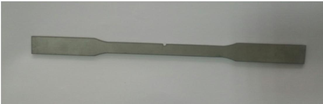
Figure 0-4: éprouvette sans traitement thermique
