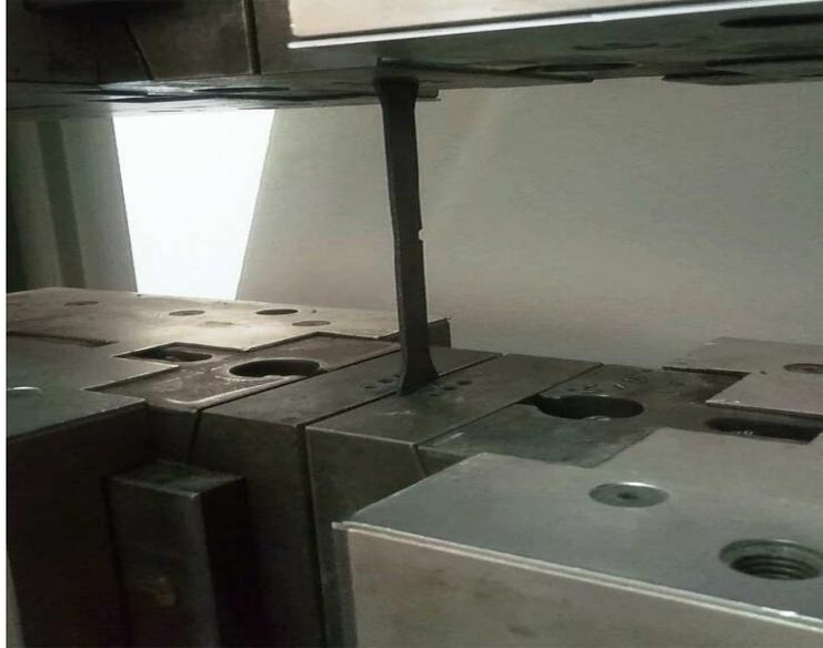
*Figure 0-9: L'éprouvette sur les mâchoires de la machine avant la rupture*
