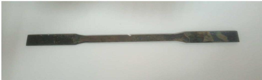
Figure 0-5: éprouvette après traitement thermique
