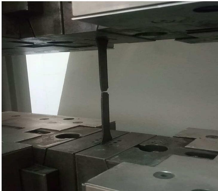
*Figure 0-10: L'éprouvette sur les mâchoires de la machine après la rupture*
