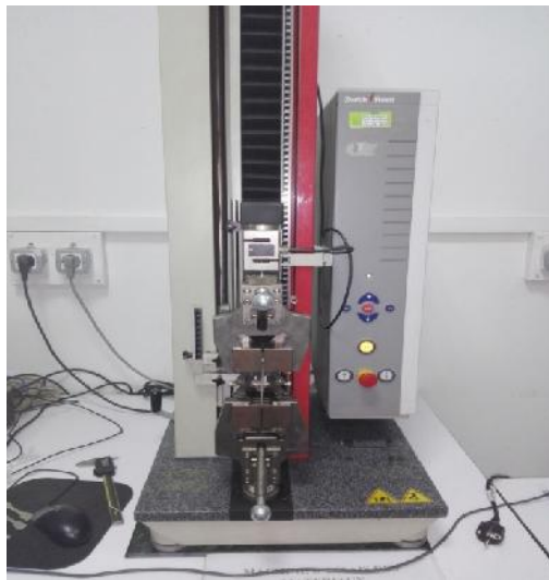
Figure 41: Machine d'essai de traction de marque ZWICK de type BTC-FR 2,5TN.N.09 (Originale, 2017).
