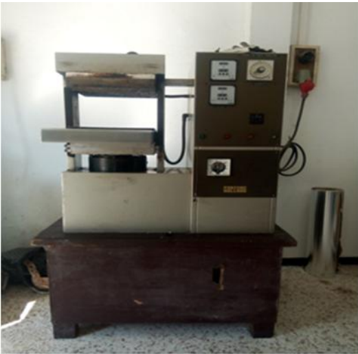
Figure 23: (a)- presse de marque FONTJINE DE MODEL TP 400, (b)- l'obtention de la plaque (Originale, 2017).
