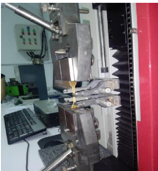
Figure 42: (a)- Eprouvette avant le test de traction et (b)- éprouvette après le test de traction (Originale, 2017).
