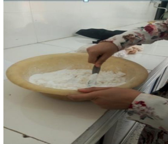
Figure 21: (a)-l'ajout du DOP dans le mélange, (b)- le mélange du compound
