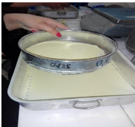
Figure 20: Tamisage de la farine du roseau à différentes granulométrie
