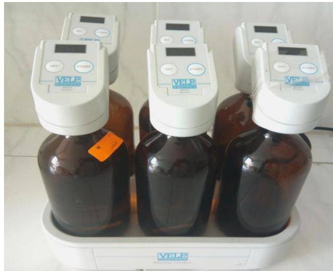
Figure III.9 : Dispositif expérimental OxiTop (DBO 5 )
