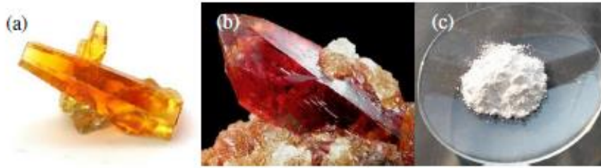
Figure II.3 : Oxyde de zinc (ZnO) : (a, b) sous forme naturelle et (c) sous forme artificielle provenant d'une synthèse sol-gel.
