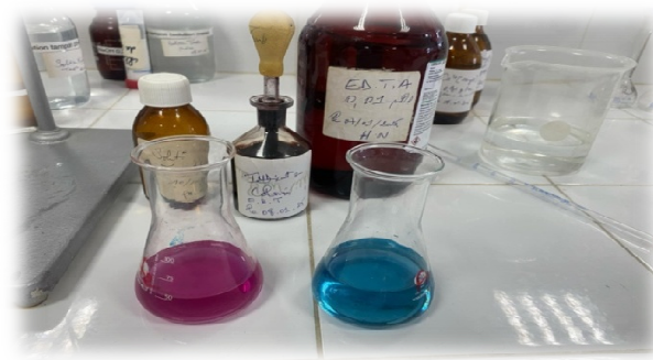
Photo 30: Dosage de la dureté par titrage : avant et après réaction
