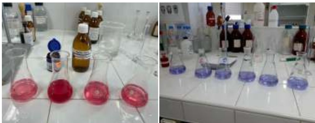
Photo 31 : Dosage du calcium par titrage : avant et après réaction.
