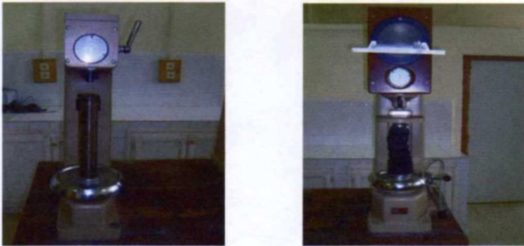
Figure V.9: Duromètre
