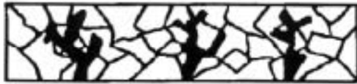
**Figure II.8:** La corrosion sous contrainte
