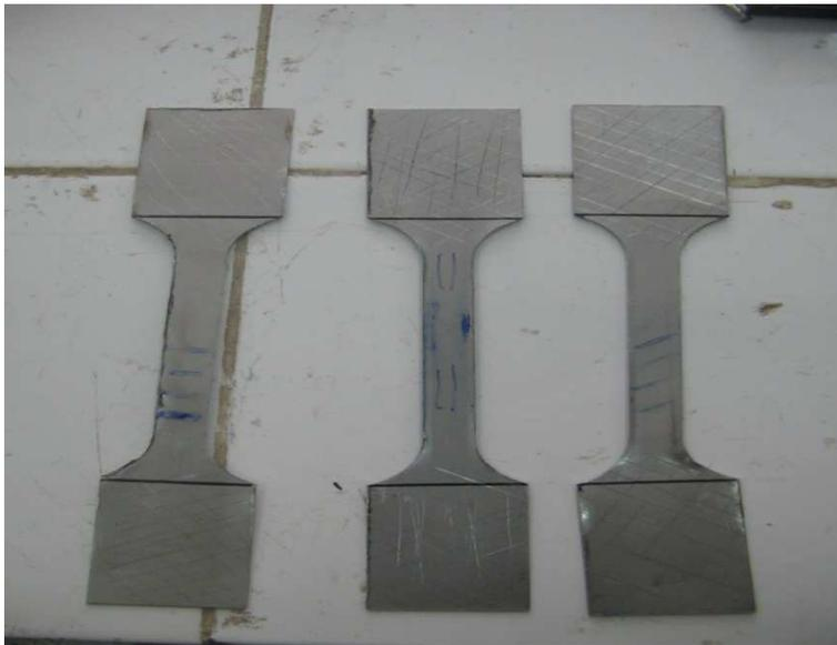
**Figure V.5:** les éprouvettes ( $0^\circ$ ,  $45^\circ$ ,  $90^\circ$ ) suivant le sens de laminage.
