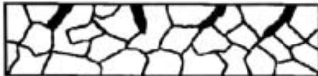
**Figure II.9:** La corrosion inter granulaire
