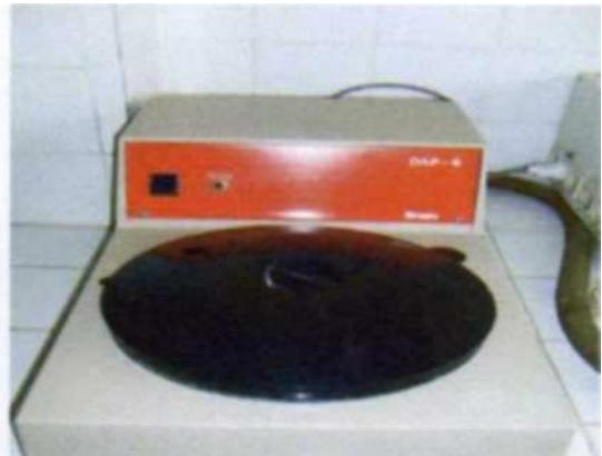
**Figure V.11 :** Polisseuse à un disque
