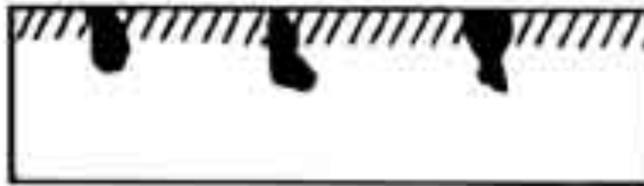
**Figure II.6:** La corrosion par piqûre.
