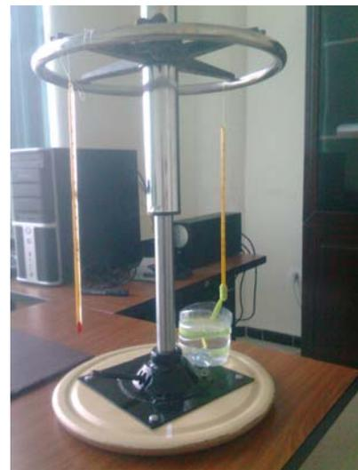
Photo IV.2 : psychromètre utilisé pour les mesures
