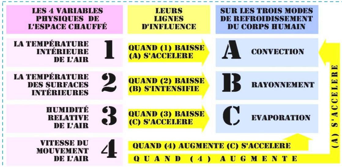
Figure I.5 : Relations entre les paramètres de confort et les modes d'échange de Chaleur
