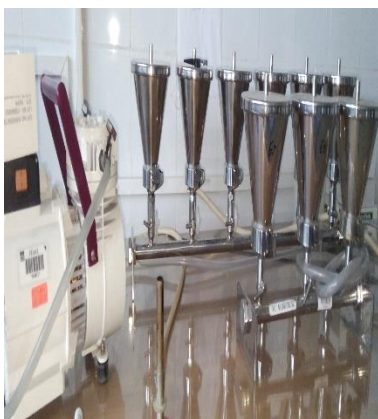
Rampe de filtration
