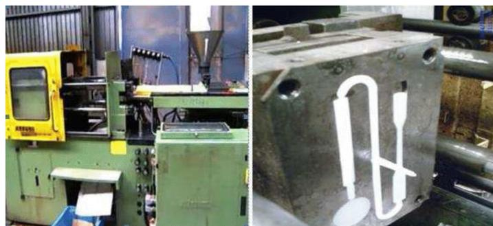
**Figure I.4** Machine à injection et moule éprouvette
