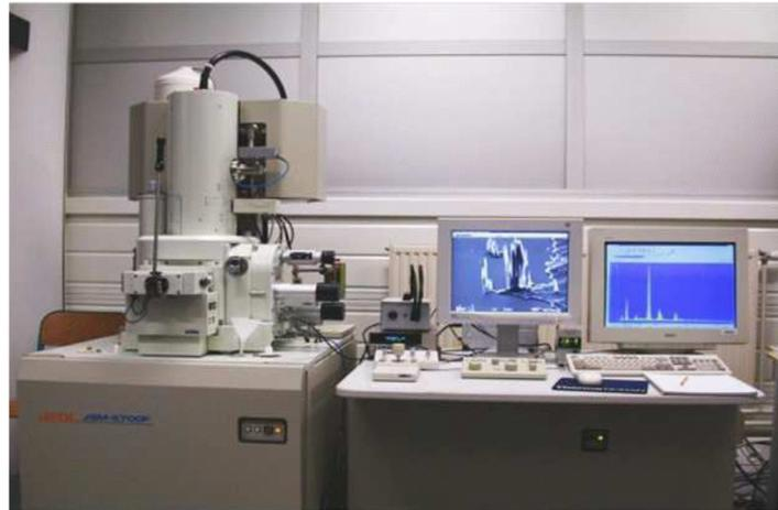
Figure III.1 : Microscope électronique à balayage(MEB).
