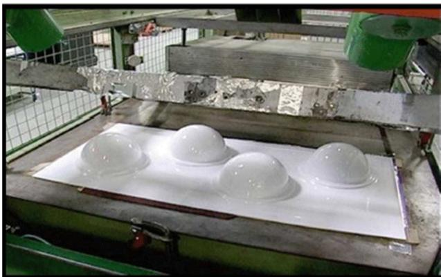
**Figure I.12** : plaque subit un thermoformage.
