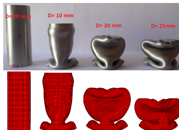
FIGURE 3.79 – Comparaison entre l'évolution numérique et expérimentale de la déformation des tubes en fonction de déplacement pour la vitesse V = 100\text{mm}/\text{min} .
