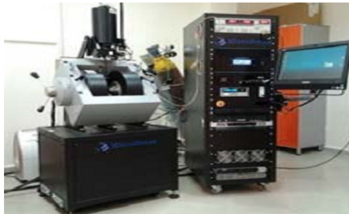
FIGURE 2.15 – Schématisation de la technique de VSM([114]).
