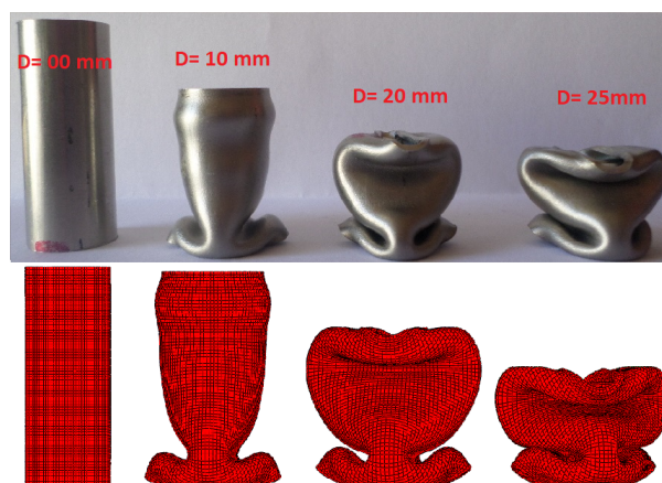
FIGURE 3.55 – Comparaison entre l’évolution numérique et expérimentale de la déformation des tubes en fonction de déplacement pour la vitesse V = 1mm/min .
