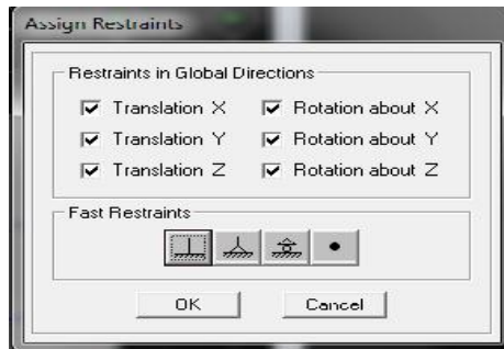
Figure IV.19: encastrement des appuis
