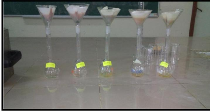
**Figure 19** : Technique de filtration (Photo originel).
