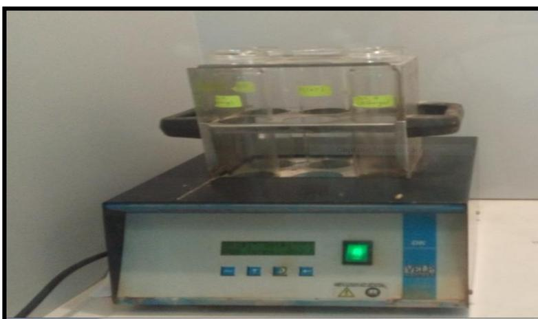
**Figure 18 :** Attaque à chaud le minéralisateur placé à l'intérieur d'une hotte (Photo originel)
