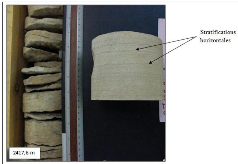
**Photo N° 07 : Echantillon de carotte montrant les grés à stratifications planes dans le puits AEH-1**
