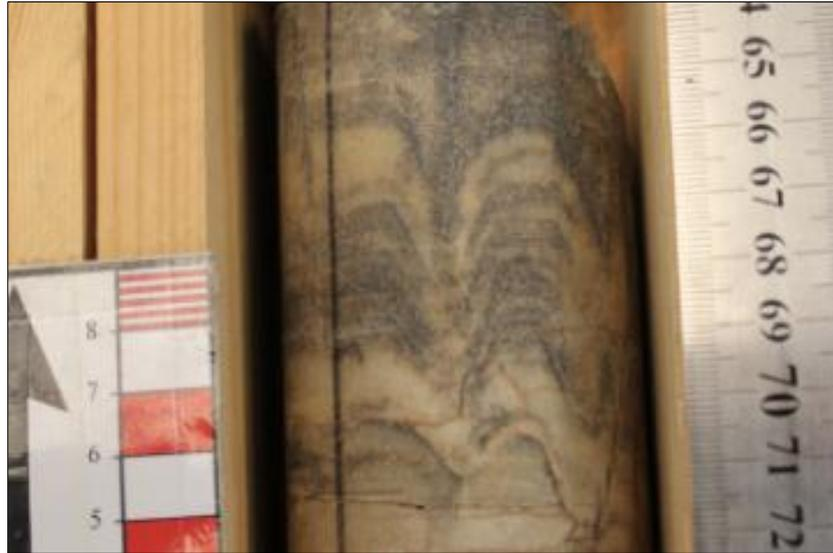
**Photo N° 11 :** Echantillon de carotte montrant une tigillite dans les grés de Djofra, puits AEH-1 **3.3.4. Les structures diagénétiques**
