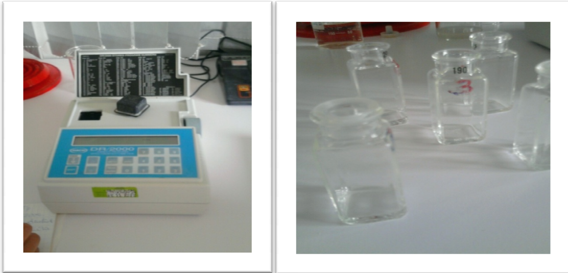
Figure (25) : Spectrophotomètre et flacons colorimétriques
