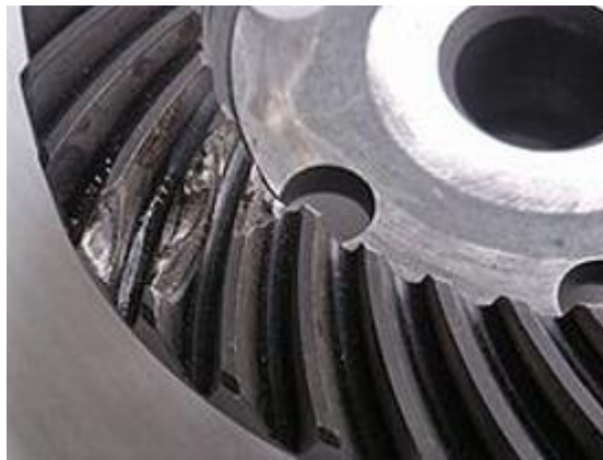
Figure III-7 : Rupture d'une dent sur une roue super conique.
