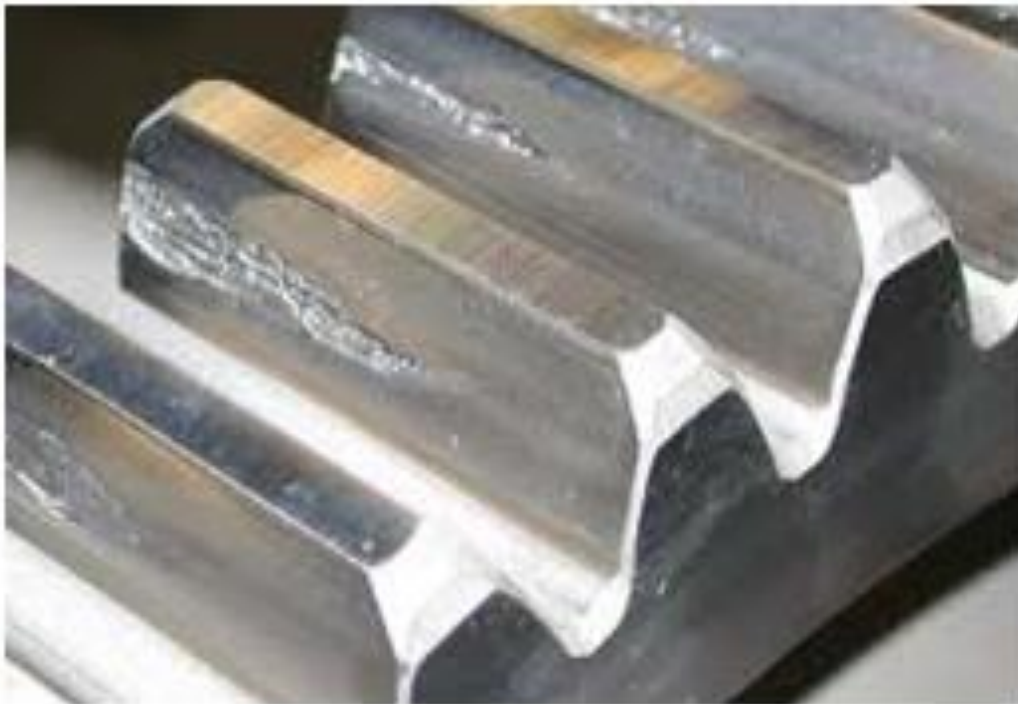
Figure II-5 : Usure sur une denture.
