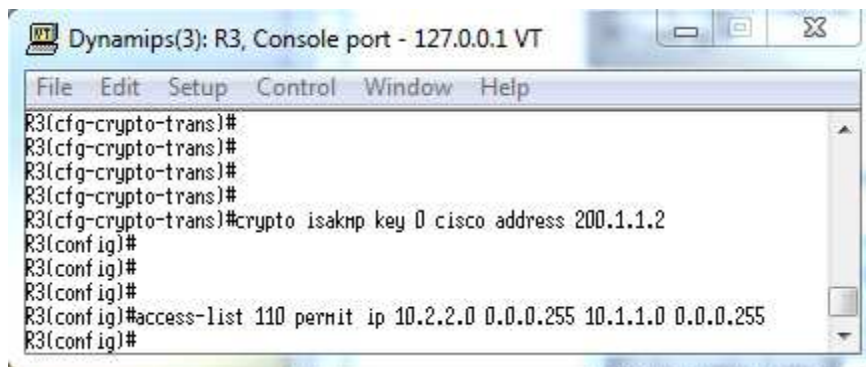
Figure IV.16. Configuration des listes de contrôle pour le site distant 1
