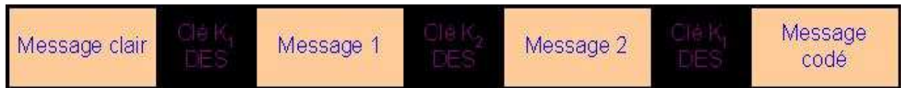
Figure II.14: Schéma de l'algorithme Triple – DES – 112 bits
