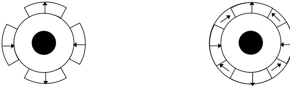
**Figure 3.4** Moteur à aimants en surface
