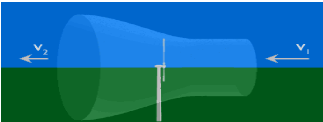
Figure I-7 : Tube de courant autour d'une éolienne.
