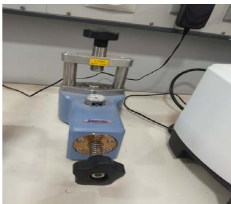
3/Presser une petite quantité du mélange à une forte pression dans un support pour former une pastille
