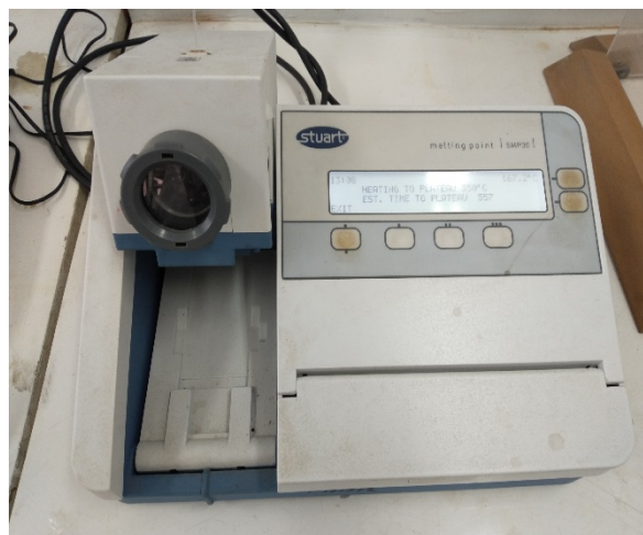
Figure III.4 : Surveillance des Pfs des produits dans les tubes capillaires.
