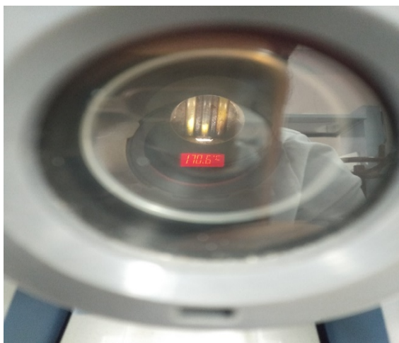
Figure III.3 : Appareil de mesure des Pfs, SMP30.
