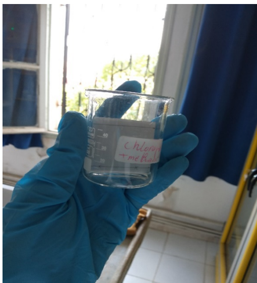
Figure IV.3 : Plaque en silice émergée dans l'éluant chloroforme + méthanol
