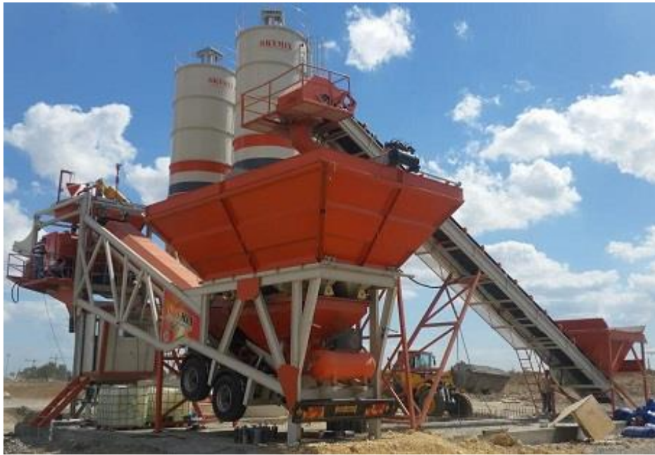
Figure I-04: Centrale à béton mobile.
