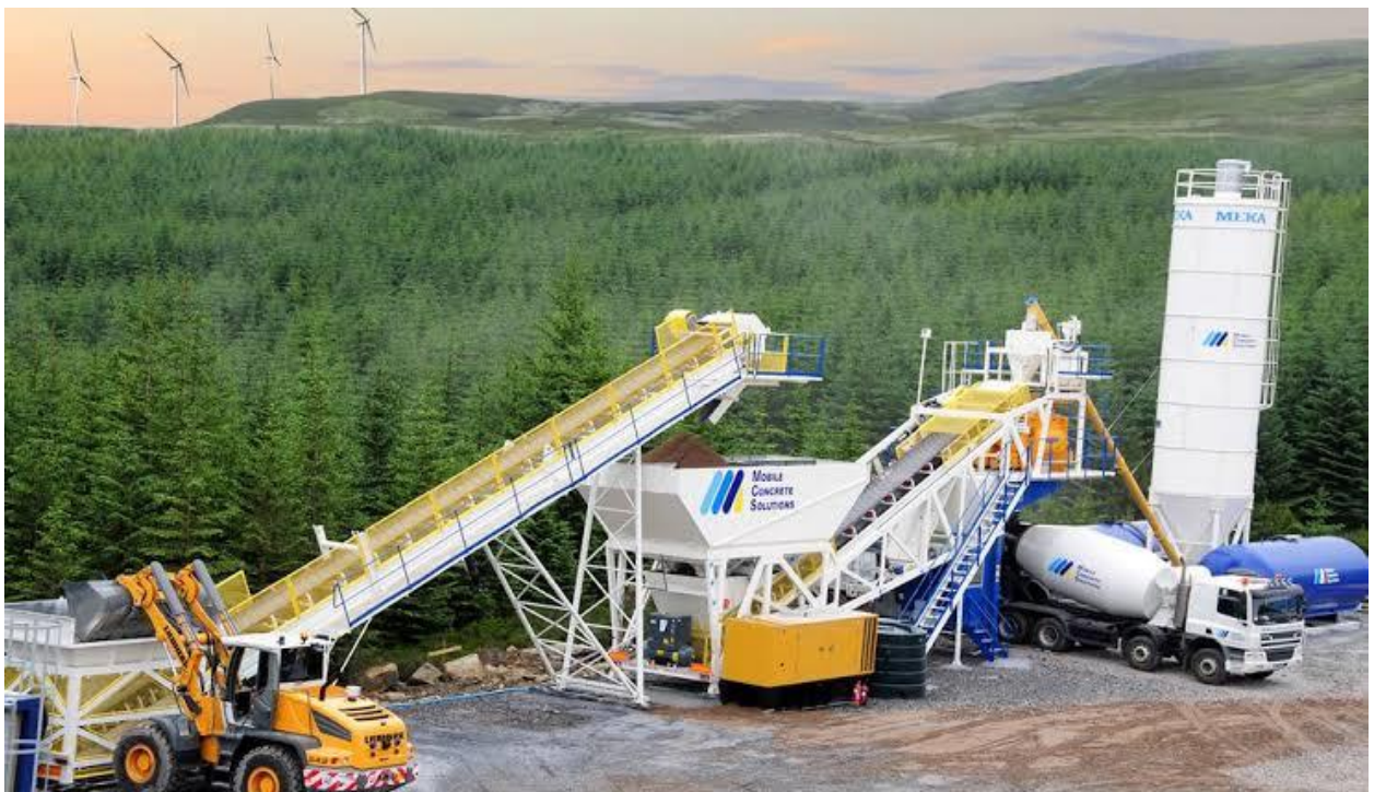
Figure I-05 : Central à béton compacte.
