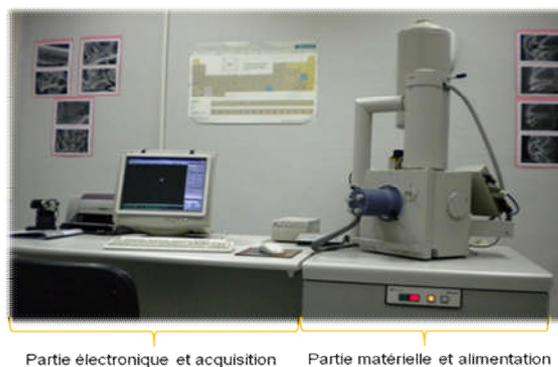
Fig. II.6 : Appareillage de MEB.
