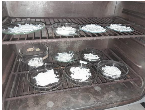
Figure 11 : Détermination de l'extrait sec du fromage dans une étuve à 105°C.
