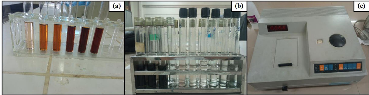
Figure 11. (a). Préparation de la gamme d'étalonnage, (b). Dilution de la gamme d'étalonnage et des échantillons, (c). Lecture au spectrophotomètre.
