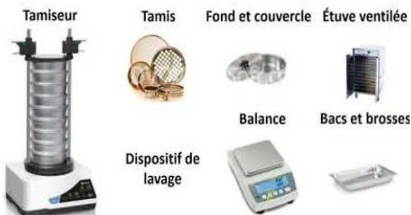
Figure IV.3. Appareillage de l'analyse granulométrique par tamisage
