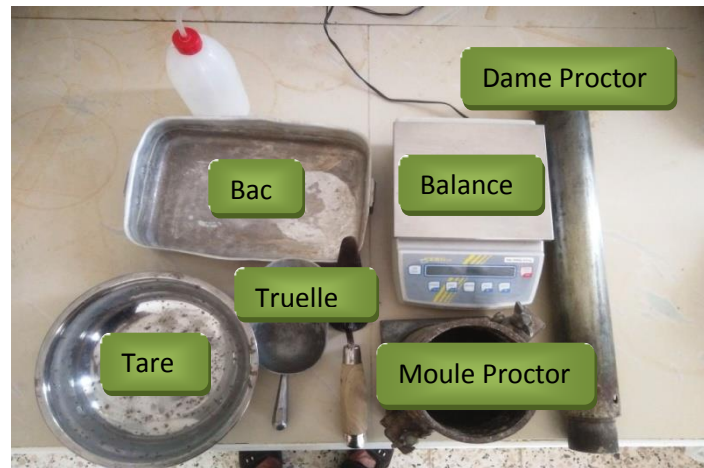
Figure V.4. Matériaux de l'essai Proctor
