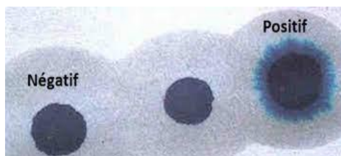
Figure IV.16. Observations de taches de l'essai VBS
