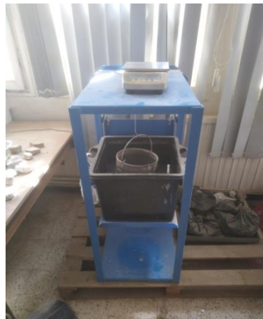
Figure IV.13. La pesée hydrostatique
