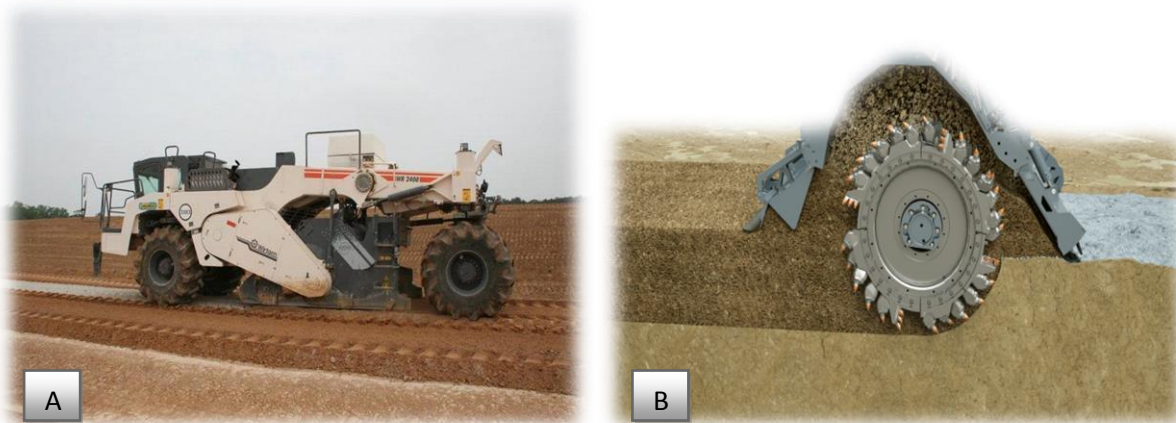
Figure II.7. (A) : Le pulvimalaxeur, (B) : La manière de malaxer le sol
