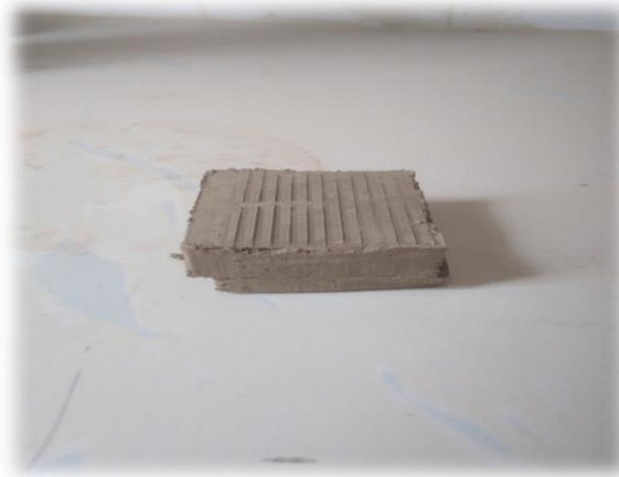
Figure V.9. L'éprouvette après cisaillement
