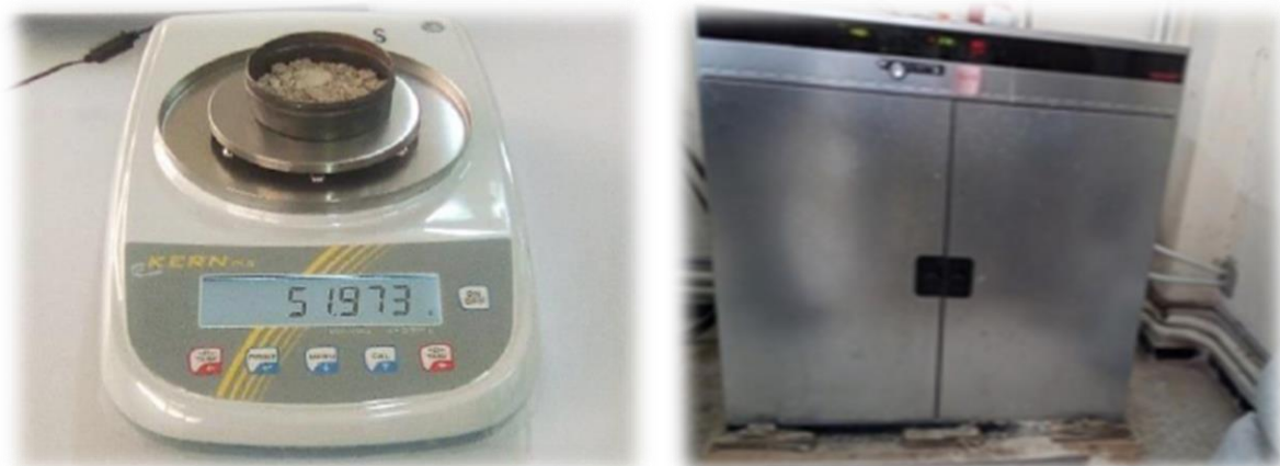
Figure IV.2. Appareillage pour déterminer la teneur en eau
