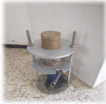
Figure V.5. Extraction d'une éprouvette avec un cric
