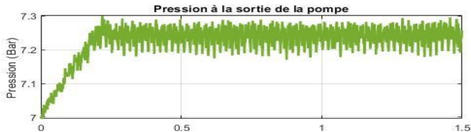
Figure III 21: graphe représente la pression à la sortie de la pompe après le 3eme défaut
