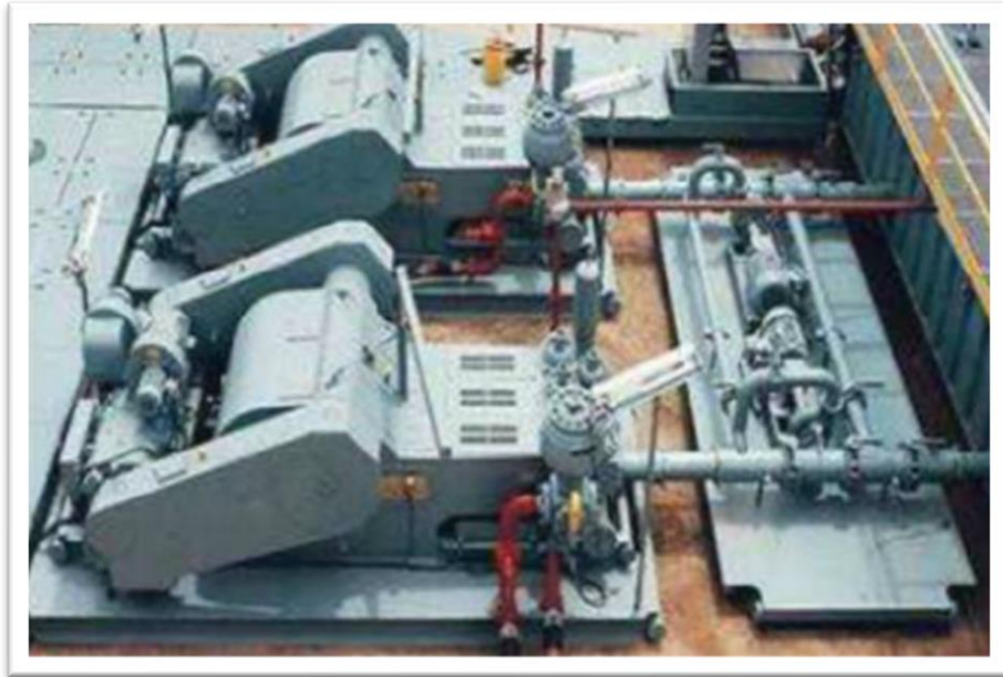
Figure II. 14: Pompe à boue triplex simple effet.
