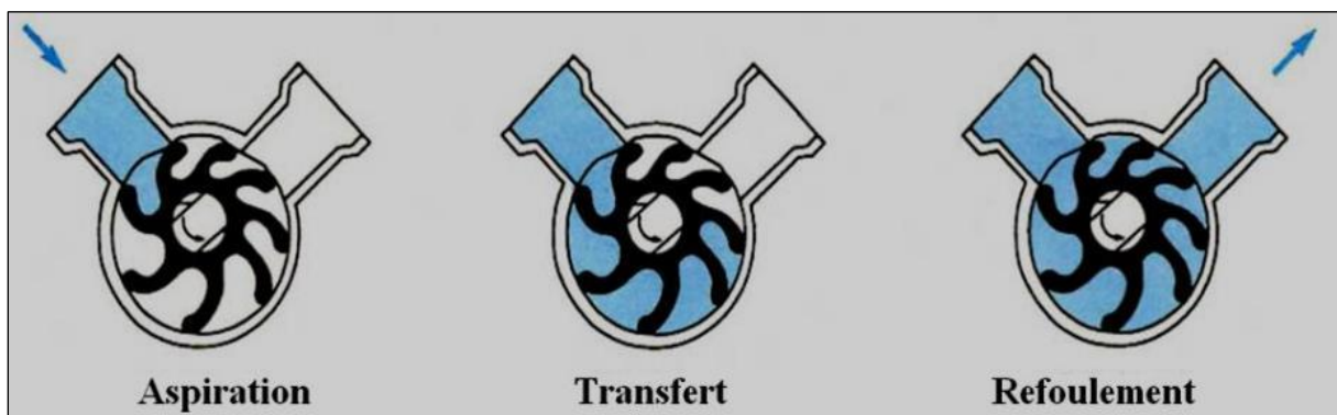
Figure II. 7: Pompes à palettes flexibles
