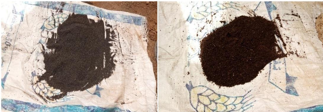
Figure 44 : Echantillons de composts tamisés à 4 mm.
