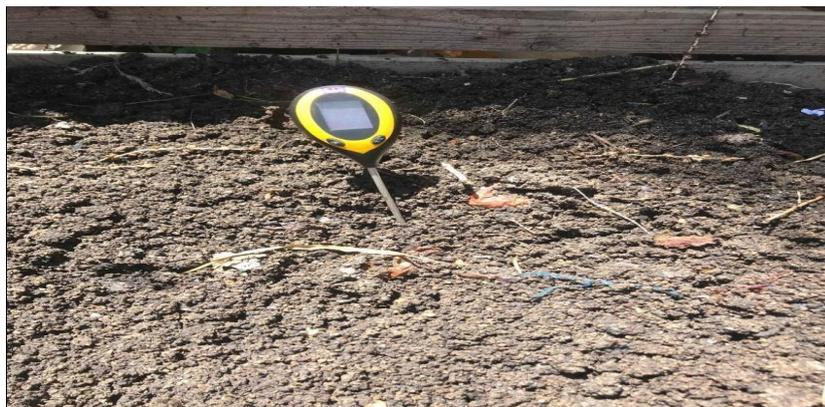
**Figure 29** : Prise du pH à l'aide d'un pH-mètre.
