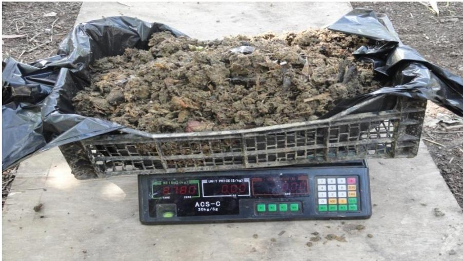
**Figure 24** : Mesure du poids des déchets en décomposition.
