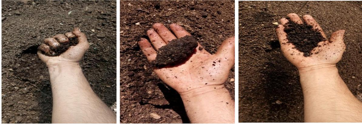
**Figure 15** : Evaluation de la teneur en eau du compost par le test de la poignée.
