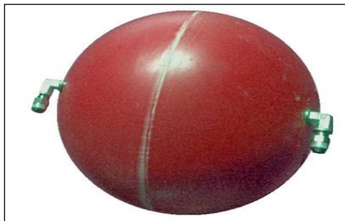
Figure I.7: Cellule de tassement à boule
