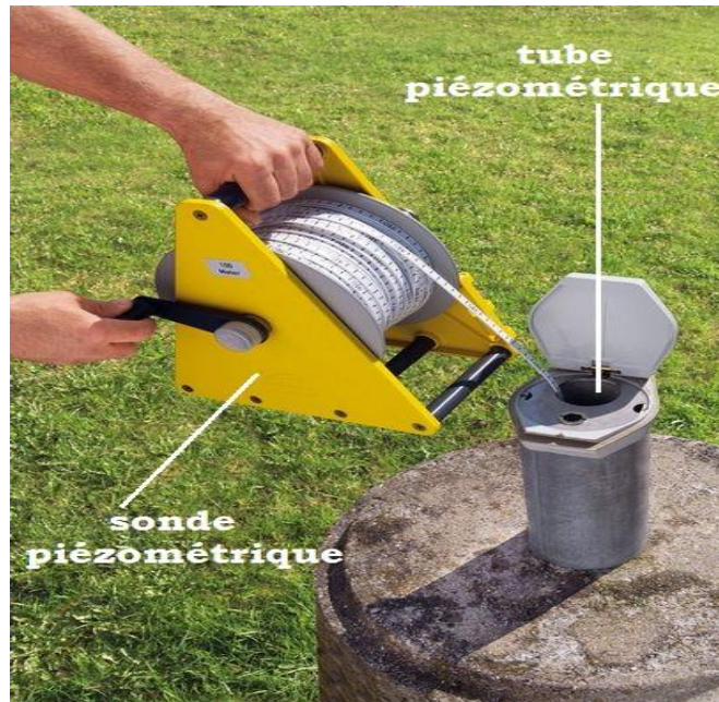
Figure I.14: Exemple d'un piézomètre ouvert
