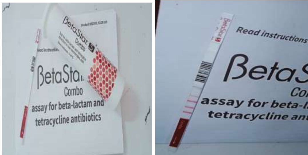
Figure 07 : test Beta Star Combo pour la détection des b-lactames et des tétracyclines
