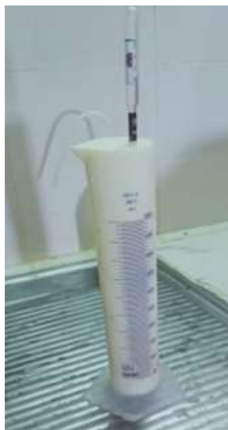
Figure 6 : lactodensimètre introduit dans l'éprouvette
