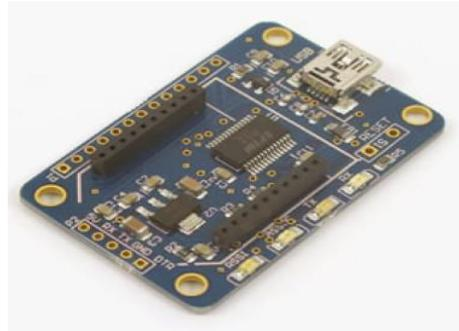
**Figure II-5** : un Adaptateur XBee
