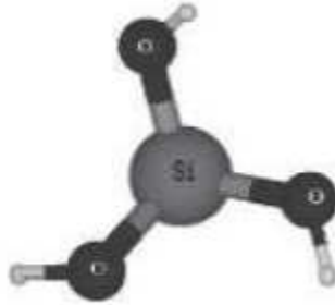
Figure 8 : Lacune d'oxygène sur un atome silicium : une des liaisons du Si est pendante [17].
