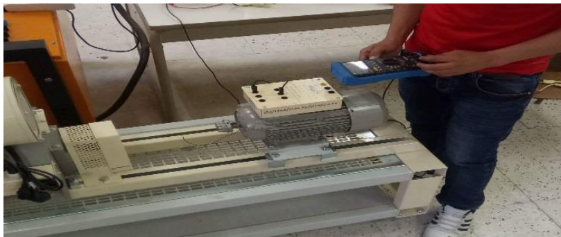
Figure (IV.4) Mesure de la résistance statorique avec un multimètre
