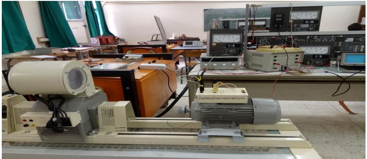
Figure (IV.11) Schéma de montage de l'essai à échelon de tension réalisé au laboratoire
