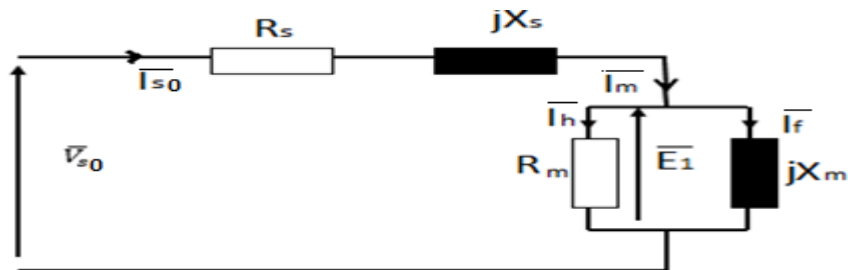
Figure (IV.7) schéma équivalent de la machine asynchrone à vide
