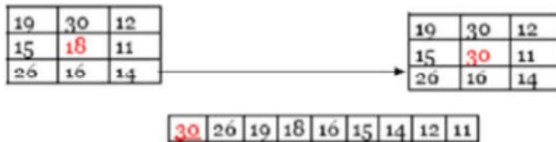
**Figure 18 : Principe du filtre maximum.**
