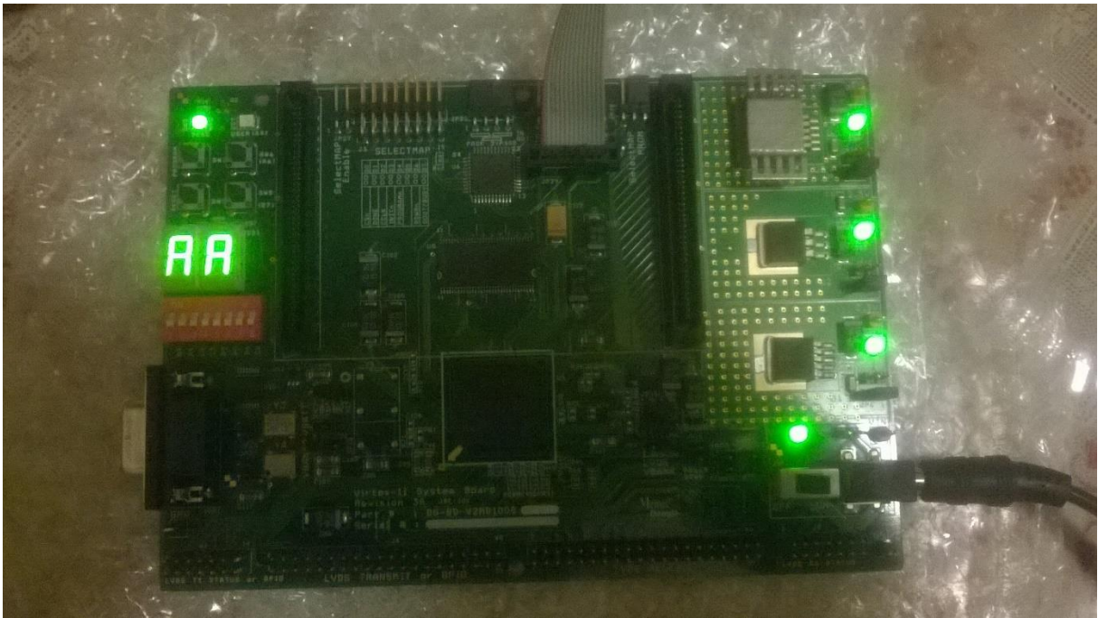
Figure VI.9 : affichage du résultat sur la carte Virtex-II
