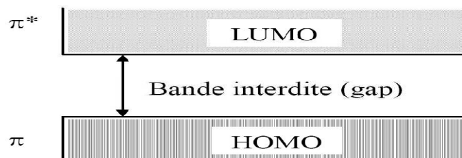
Figure II.11 : Structure de bande d'un polymère conjugué [21]
