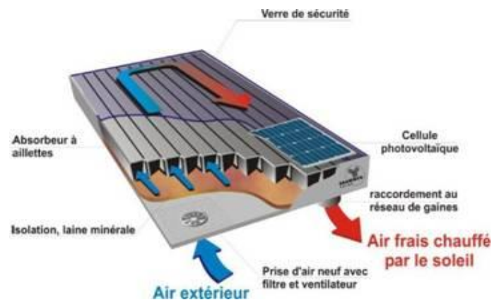
Figure. I.18 : Capteur solaire a air.
