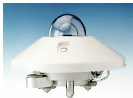
Figure.I.10 : pyranomètre pour la mesure du rayonnement global.
