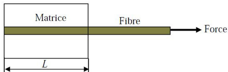
Figure III.13 : Schéma d'une éprouvette modèle soumise à un test pull-out
