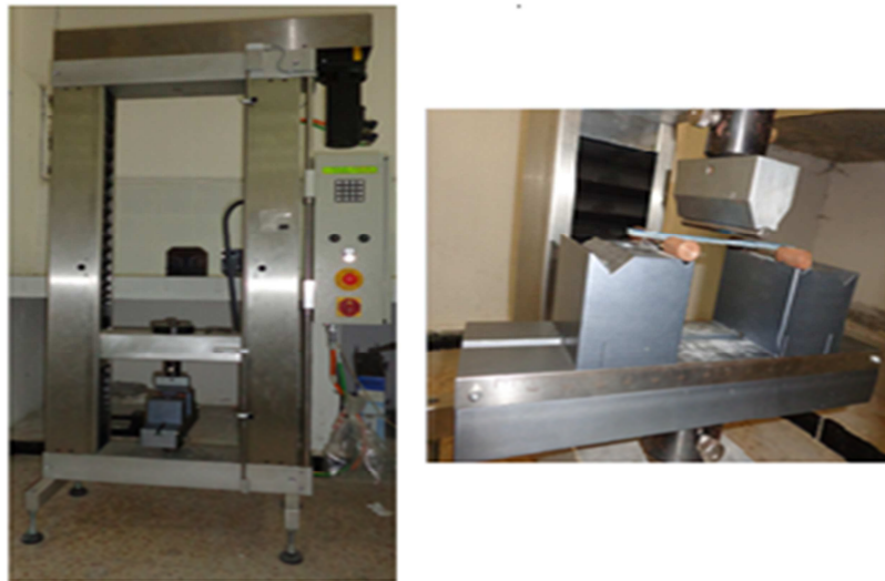
Figure V.5 : Machine et dispositif de flexion trois points.
