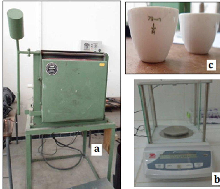
Figure V.33 : Matériels utilisés pour la perte au feu ; a) Four, b) Balance de précision c) Creuset
