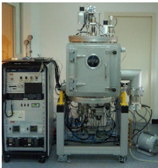
*Figure III.3 Une image du bâti d'évaporation d'OLEDs de la centrale de proximité en nanotechnologies de l'Université Paris nord.*
