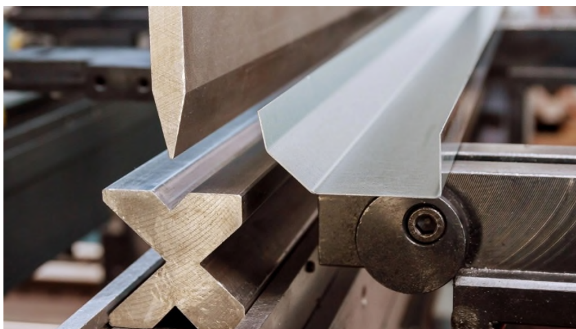
Figure 1-1: pliage de tôle
