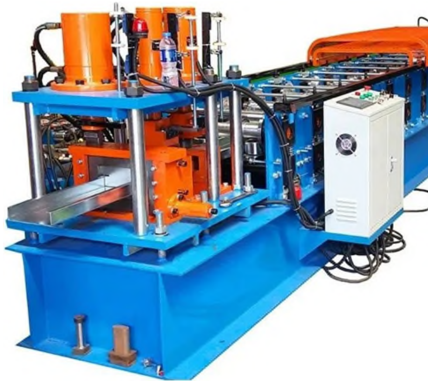
Figure 1-2: Formage par profilage
