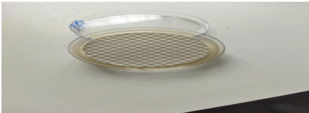
Figure 15 : Milieu CCA pour l'incubation des Coliformes totaux et fécaux (Photographie originelle, 2023).
