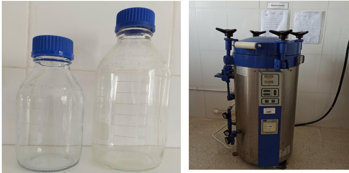
Figure 5 : Autoclave et flacons utilisés pour les prélèvements physico-chimiques et bactériologiques (Photographie originale, 2023).
