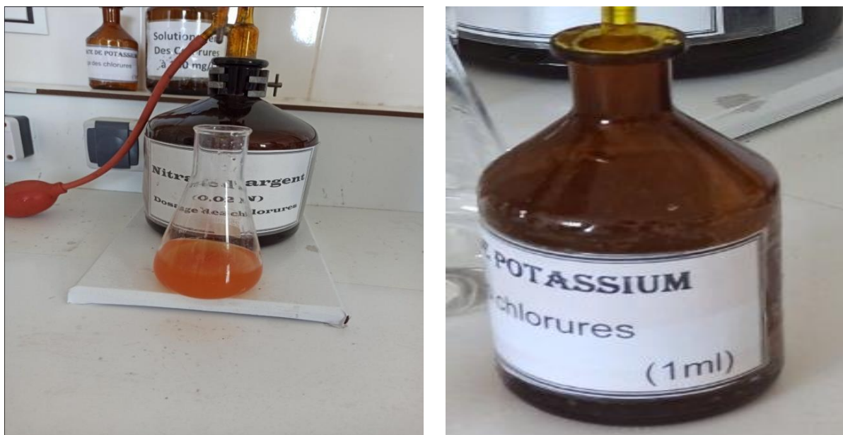
Figure 12 : Dosage des chlorures (Photographie originale, 2023).
