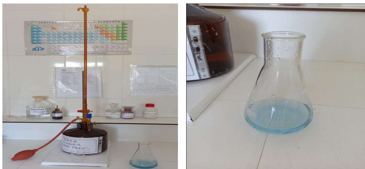
Figure 10 : Dosage volumétrique du calcium (Photographie originale, 2023).
