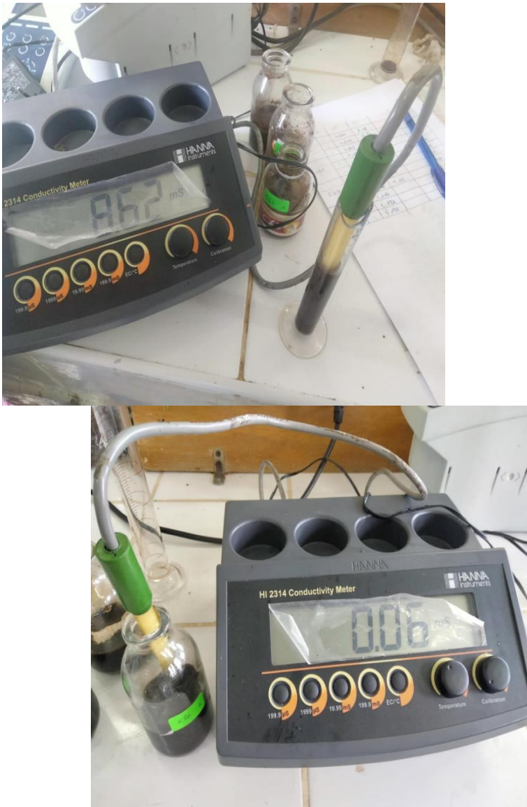
Figure22 : mesure de conductivités électriques des margine par un conductimètre
