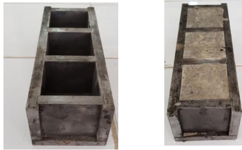
Figure III.4. Moule de confection des éprouvettes 5 \times 5 \times 5 \text{ cm}^3
