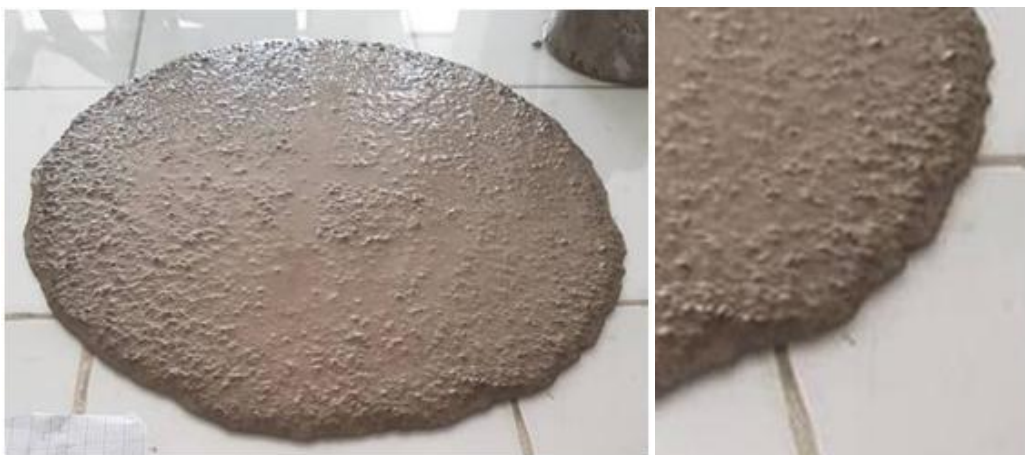
Figure IV.5. Ségrégation du mortier
