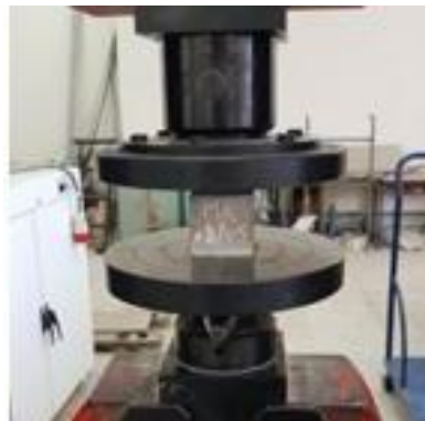
Figure III.6. Mortier soumis à la compression pure
