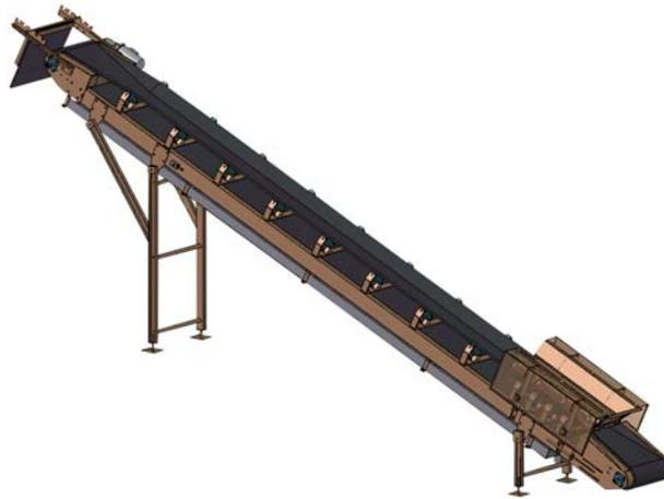
**Fig. I.6 :** Convoyeur à bande
