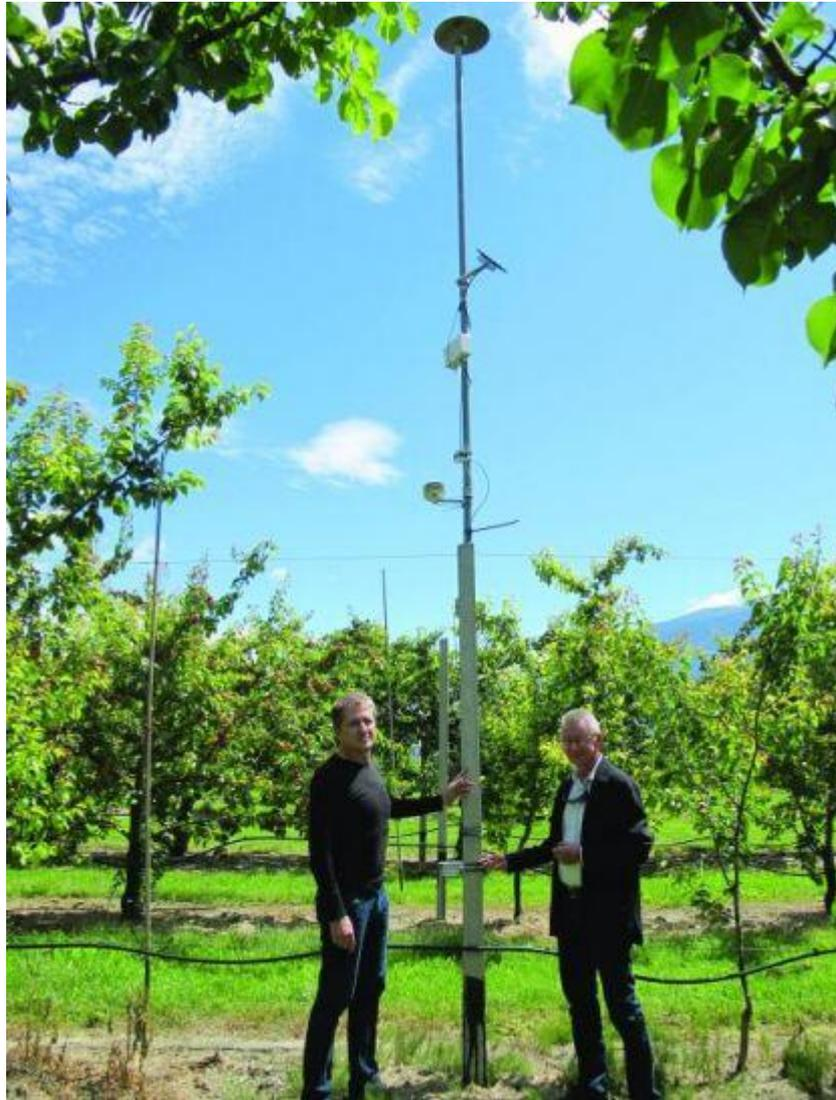
Figure 6 : application des RCSF pour le relevé météorologique.
