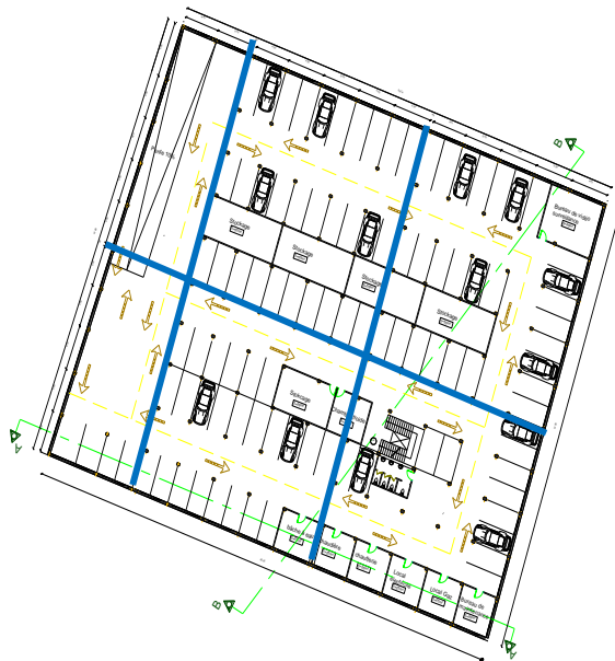
Figure 185: les joint de dilation Source : auteures
