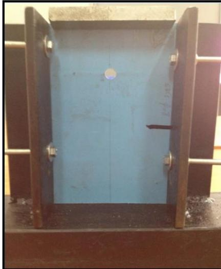
**Figure 3.10** Support permettant de réaliser les tests de compression
