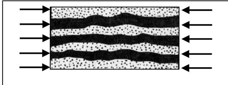
*Figure 2.3- Compression axiale d'un composite*
