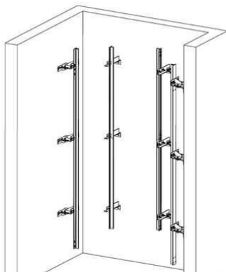
Figure II-16 : Placement des rails dans les parois de la gaine.
