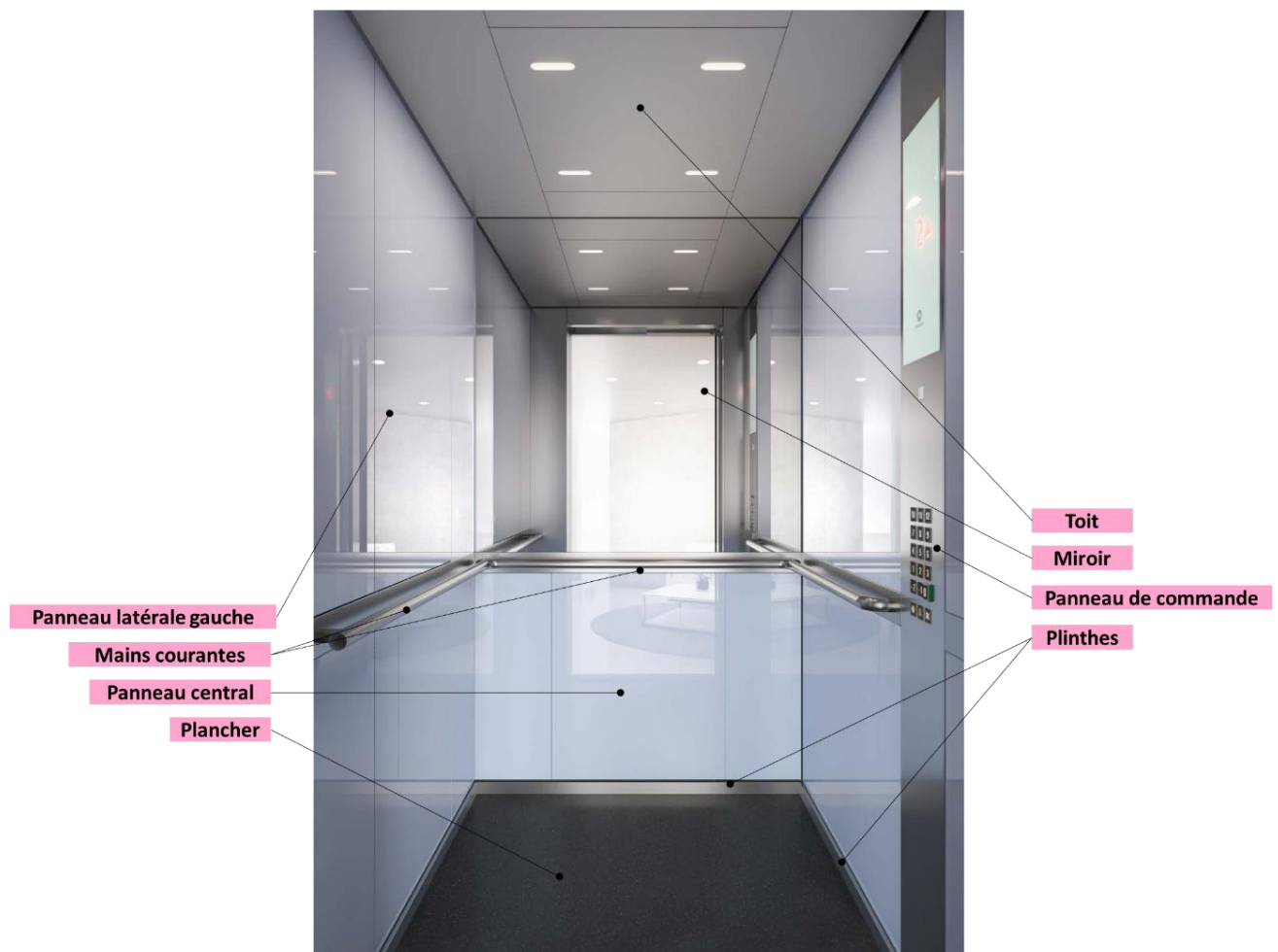
Figure IV-17 : Schéma intérieur d'une cabine finis.
