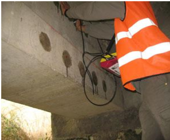
Figure 75: Mode d'usage de l'appareil ultra-son
