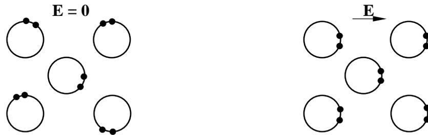
Figure 2.4. Représentation schématique de la polarisation dipolaire.
