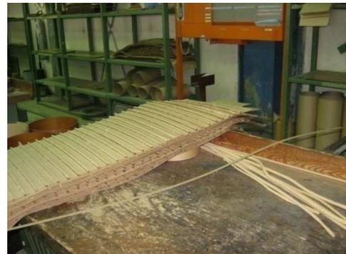
Figure 4.2. Papier préparé pour un transformateur de 400 kVA/30 kV.
