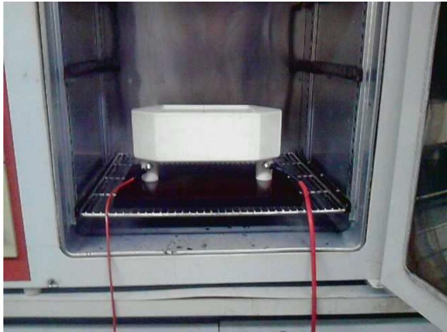
Figure 4.33. Cellule d'essai à l'intérieur de l'étuve de séchage.
