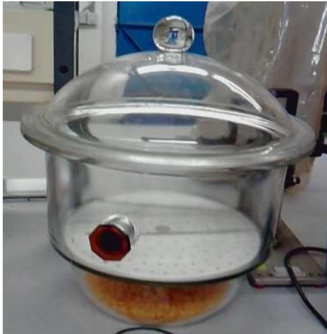
Figure 4.29. Dessiccateur employé pour le conditionnement des éprouvettes.
