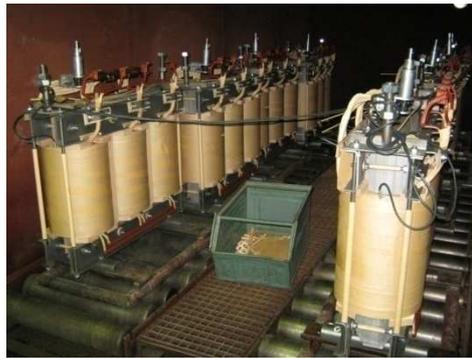
Figure 4.3. Séchage des parties actives du transformateur.
